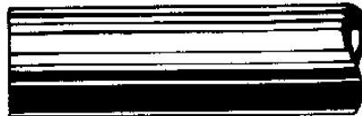
Striplengte (L) opgegeven in de persgegevens wordt met een in harde rubber gegoten stalen borstel afgaborsteld tot aan de staalinlage.
